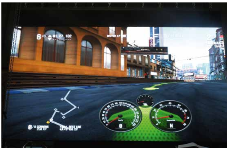
L - 7 SI Display 5.2 x 2.9 m | 9 x 5 Module, 7,2 mm Pixelabstand
